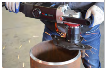
PIPE BEVELING ATTACHMENT ID ≥ 110 MM OD ≥ 150 MM
