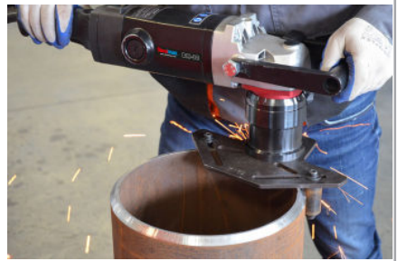
PIPE BEVELING ATTACHMENT ID ≥ 110 MM OD ≥ 150 MM
